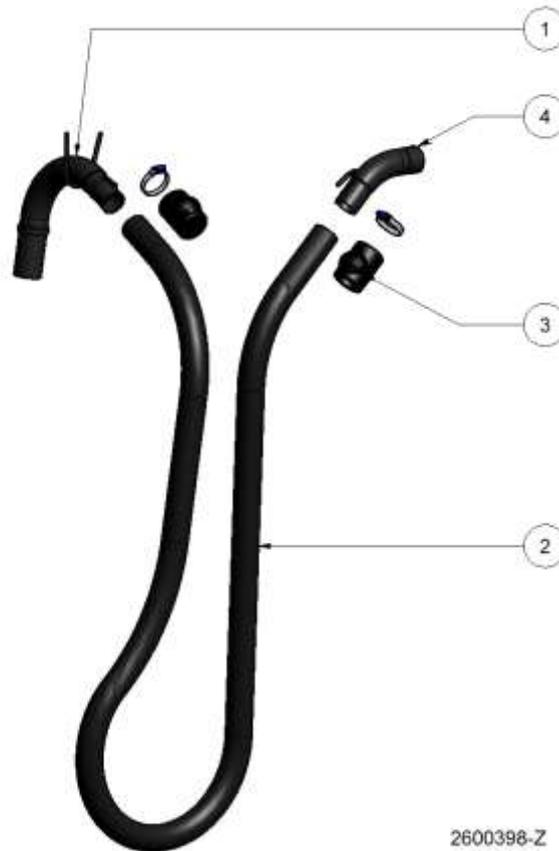
12.10.1 Ersatzteilliste Saugschlaucheinheit DN 50, alle Typen
