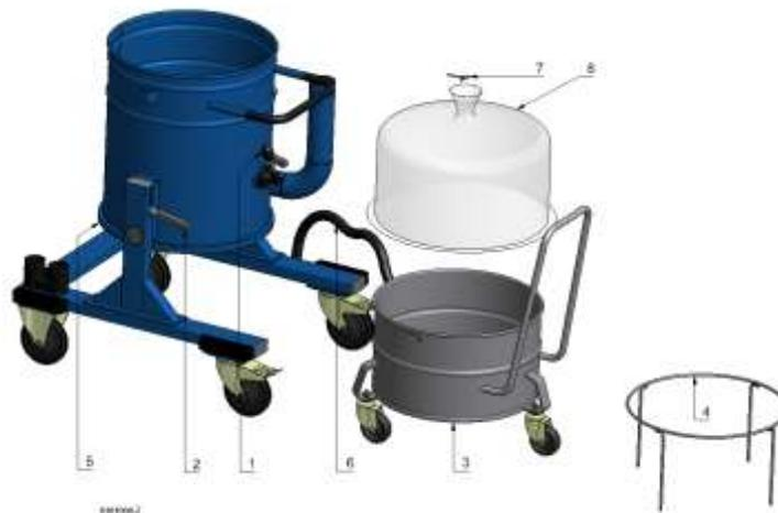
Bevor Sie den Staubbehälter entleeren, das Gerät abschalten und den Motorstillstand abwarten. Zusätzlich sollte der Taschenfilter "1" abgerüttelt werden, danach ca. 60 sec. warten bis sich der Staub im Sammelbehälter abgesetzt hat.
