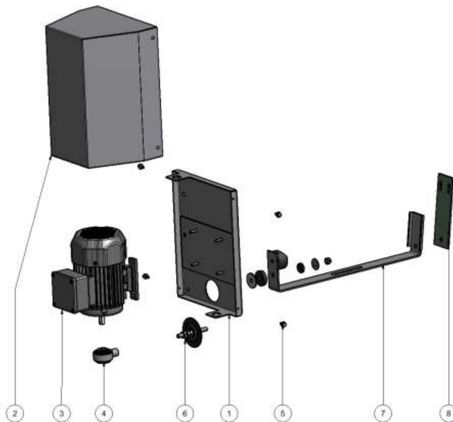
**12.9.1 Elektrische Filterabreinigung, ohne Steuerschrank, (2380187)**
