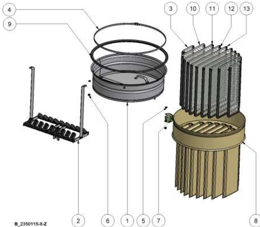
12.6.1 Ersatzteilliste/Zeichnung Taschenfilter 3,2m<sup>2</sup>, Kat. "L" as/"M" as (2350202/2350115)
